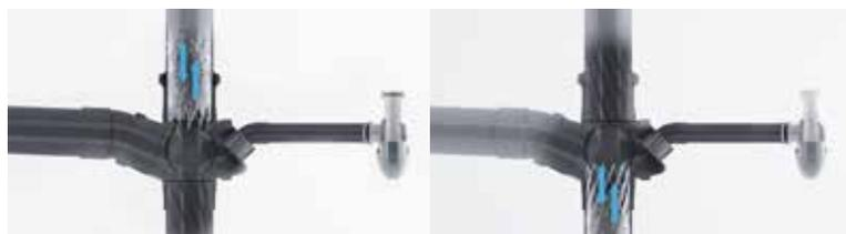
Le système Chutunic® permet un éclatement de l'eau contre la paroi interne du tube grâce à ses nervures spiralées associées à des culottes optimisées. Le piston hydraulique disparaît, permettant à l'air de circuler librement au centre du tube. Le désiphonage est ainsi évité, ainsi que les gargouillements et les odeurs.
