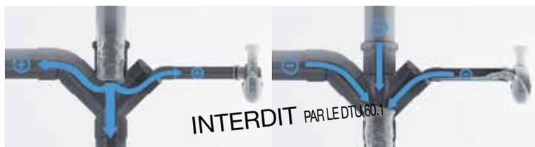
La chute d'une chasse d'eau provoque un "piston hydraulique". En descendant, celui-ci crée une surpression ⊕ qui provoque des gargouillements dans les siphons.
