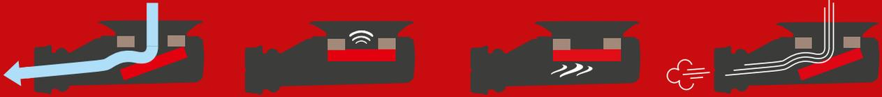
L'eau de la douche exerce une pression supérieure à la force magnétique des aimants. Le clapet magnétique mobile s'ouvre pour permettre l'écoulement. Plus le débit de l'eau augmente au cours de la douche, plus le clapet mobile s'ouvre.
