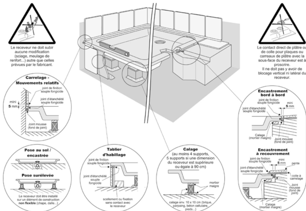
Le receveur ne doit subir aucune modification (sciage, meulage de renfort...) autre que celles prévues par le fabricant.
