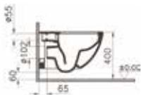
Un tuyau supplémentaire pourrait être nécessaire suivant l'épaisseur du mur.
