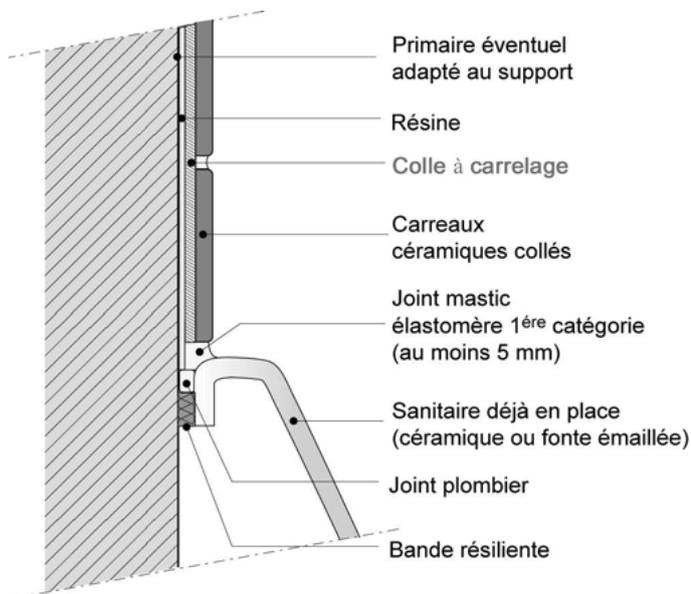
*Profil 2 - Exemple de profilé de raccordement à mettre en place entre la paroi et l'appareil sanitaire (dans ce cas, pas de joint au mastic en finition autour du receveur).*
