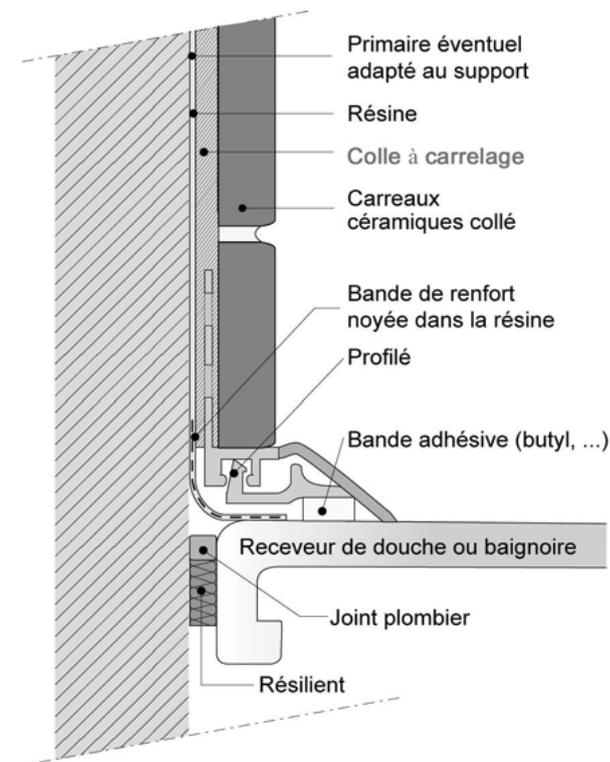
*Profil 3 - Traitement de petites parties horizontales entre la paroi et le receveur de douche ; exemple de finition à l'aide d'un mastic élastomère 1<sup>ère</sup> catégorie à la périphérie du receveur de douche.*
