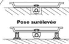
Le receveur doit être installé sur un élément de construction non flexible (chape, dalle...)
