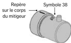
La manette doit se retrouver à la fin avec le symbole 38 à l'axe du mitigeur, ou face au repère sur le corps du mitigeur lorsqu'il y en a un.
